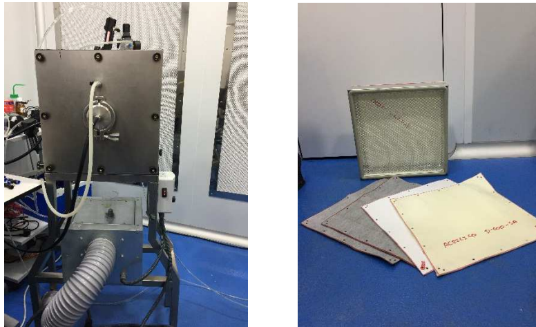
Figura 17 : Dispositivo experimental y telas estudiadas para la evolución de la eficacia de filtración frente a NMs
