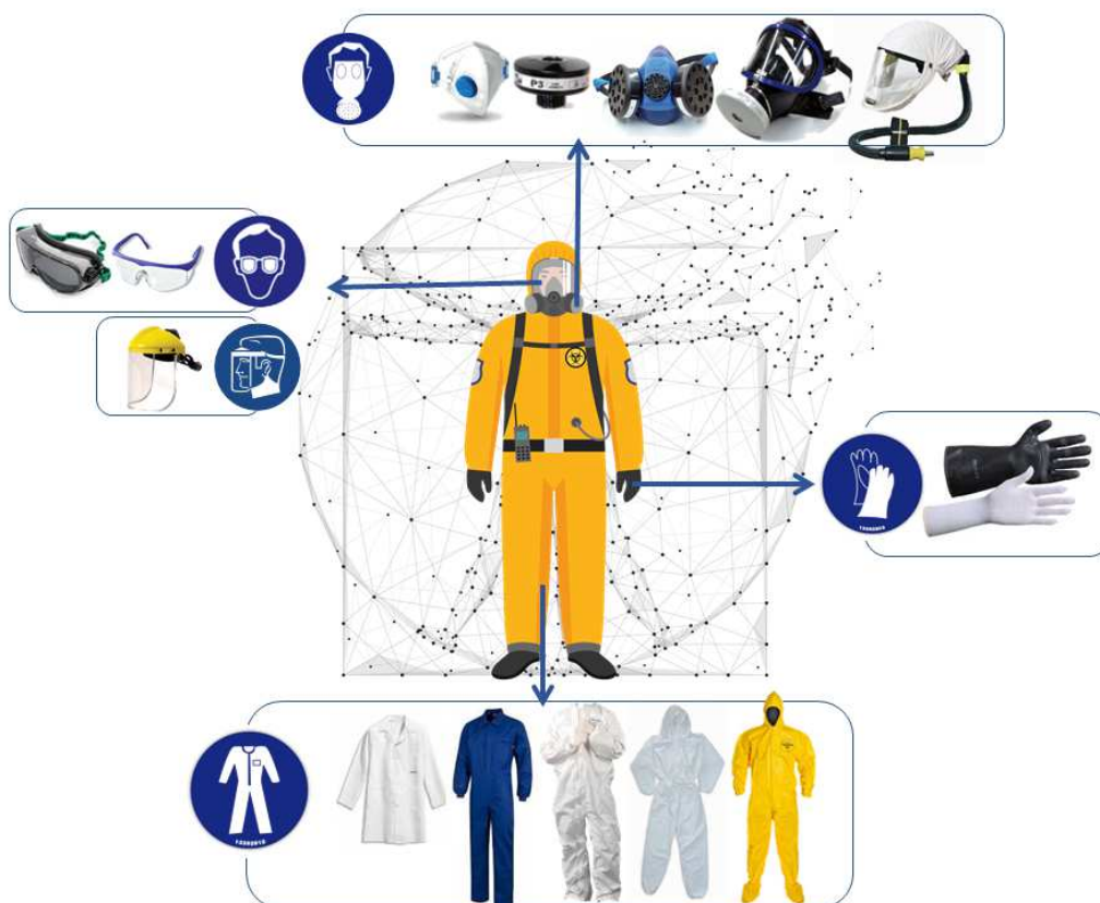
Figura 6. Representación de los equipos de protección utilizados generalmente frente a nanomateriales.
