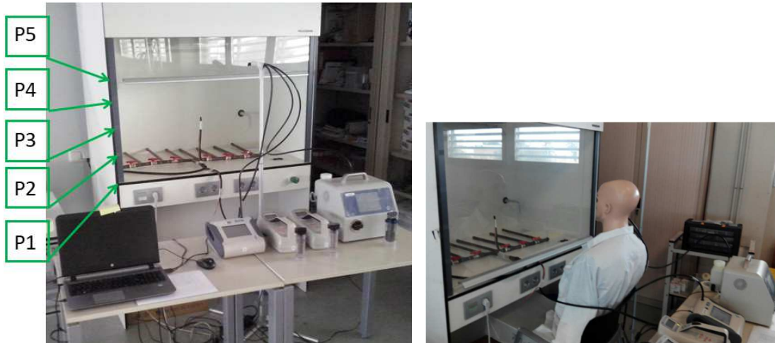
Figura 14. Dispositivo experimental para evaluar la eficacia de campanas de laboratorio frente a nanomateriales.
